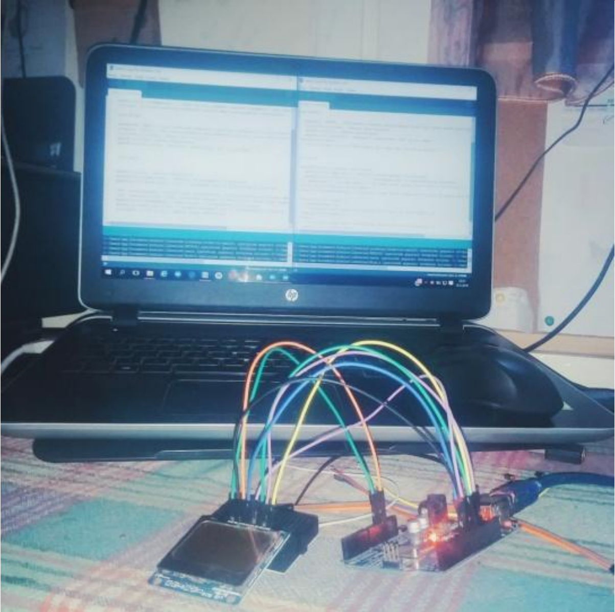
Şekil 3: Arduino Uno İle Gösterge (Display) Sürme Projesi
